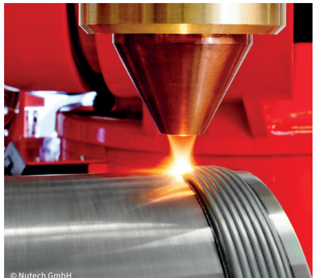
Deposición de metal por láser
