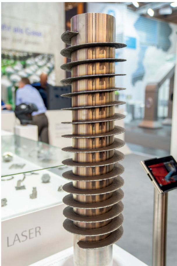
Sinfín fabricado mediante DED-LB
