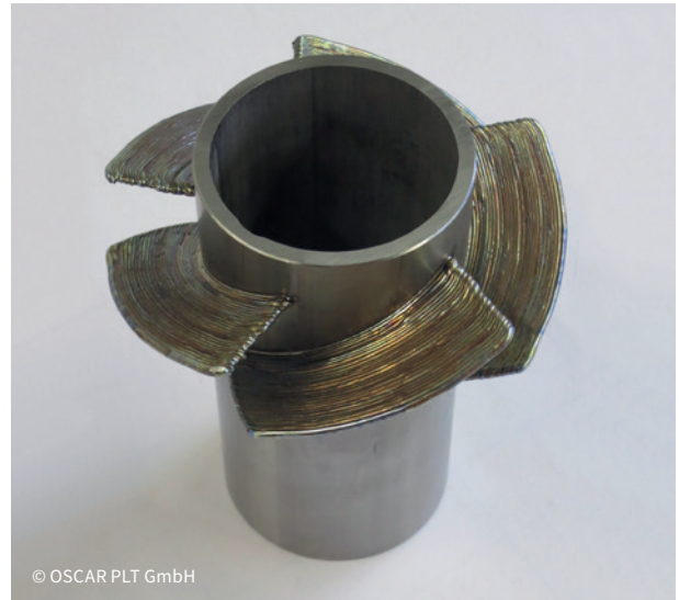
Deposición directa de energía coaxial - haz láser con hilo
